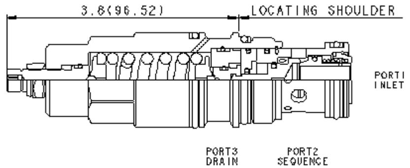
Les valves de séquence à action directe avec drainage externe et clapet anti-retour alimentent un circuit secondaire en huile dès que la pression à l'entrée (orifice 1) est supérieure au tarage de la valve. De plus, ces valves intègrent un clapet anti-retour qui permet un passage libre de l'orifice 2 (séquence) vers l'orifice 1 (entrée). La pression de tarage de la valve de séquence commande la pression à l'orifice 1 en fonction de la pression au drain (orifice 3).
