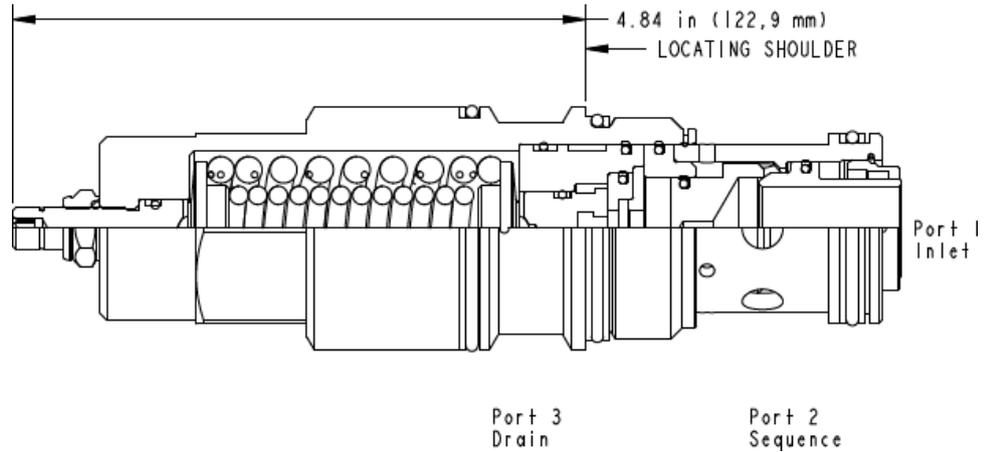
Les valves de séquence à action directe avec drainage externe et clapet anti-retour alimentent un circuit secondaire en huile dès que la pression à l'entrée (orifice 1) est supérieure au tarage de la valve. De plus, ces valves intègrent un clapet anti-retour qui permet un passage libre de l'orifice 2 (séquence) vers l'orifice 1 (entrée). La pression de tarage de la valve de séquence commande la pression à l'orifice 1 en fonction de la pression au drain (orifice 3).
