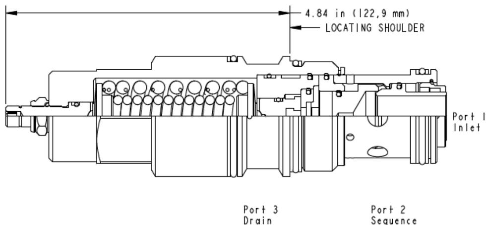
Ein direktbetätigtes Druckfolgeventil mit Rückschlagventil erlaubt den Durchfluss in einen zweiten Kreis, sobald der Druck an Anschluss 1 den Einstellwert des Ventils übersteigt. Zusätzlich verfügt dieses Ventil über ein Rückschlagventil, das den Durchfluss von Anschluss 2 (Folge) nach Anschluss 1 (Zulauf) ermöglicht. Die Druckeinstellung eines Druckfolgeventils regelt den Druck an Anschluss 1 abhängig vom Druck am Leckölanschluss 3.
