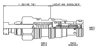
Selbstentlastende Druckfolgeventile entladen selbsttätig und öffnen vollständig von Anschluss 1 nach 2, sobald der eingestellte Druck an Anschluss 1 erreicht ist. Die Druckeinstellung an Anschluss 1 ist abhängig vom Druck an Anschluss 3. Das Ventil bleibt offen, solange der Druck an Anschluss 1 den Druck an Anschluss 2 übersteigt. Zum Rückführen des Ventils in die geschlossene
