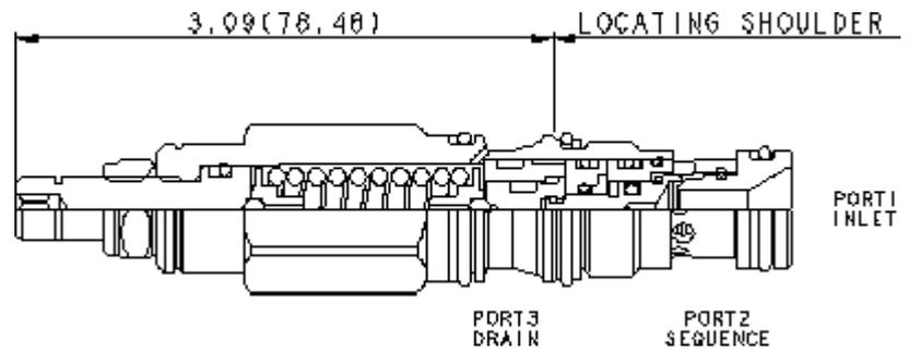
Ein direktbetätigtes Druckfolgeventil erlaubt den Durchfluss in einen zweiten Kreis, sobald der Druck an Anschluss 1 den Einstellwert des Ventils übersteigt. Die Druckeinstellung eines Druckfolgeventils regelt den Druck an Anschluss 1 abhängig vom Druck am Leckölanschluss 3.
