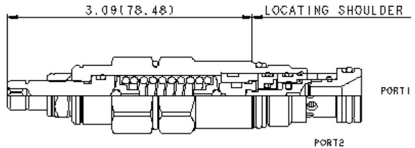
Direktbetätigte, atmosphärisch entlastete Druckfolgeventile erlauben den Durchfluss in einen zweiten Kreis, sobald der Druck an Anschluss 1 den Einstellwert des Ventils übersteigt. Die Druckeinstellung dieses Druckfolgeventils regelt den Druck an Anschluss 1 in Abhängigkeit von der atmosphärischen Entlastung.
