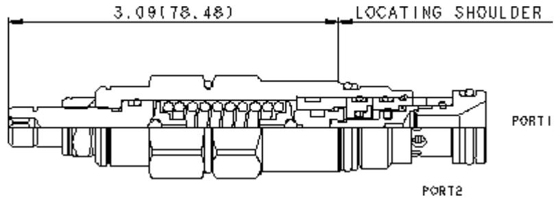
Les valves de séquence à action directe avec évent atmosphérique alimentent un circuit secondaire en huile dès que la pression à l'entrée (orifice 1) est supérieure au tarage de la valve. La pression de tarage de la valve de séquence commande la pression à l'orifice 1 en fonction de la pression à l'évent atmosphérique.
