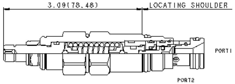
Les valves de séquence à action directe avec évent atmosphérique alimentent un circuit secondaire en huile dès que la pression à l'entrée (orifice 1) est supérieure au tarage de la valve. La pression de tarage de la valve de séquence commande la pression à l'orifice 1 en fonction de la pression à l'évent atmosphérique.
