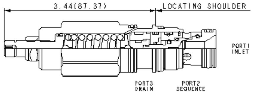
Les valves de séquence à action directe avec drainage externe alimentent un circuit secondaire en huile dès que la pression à l'entrée (orifice 1) est supérieure au tarage de la valve. La pression de tarage de la valve de séquence commande la pression à l'orifice 1 en fonction de la pression au drain (orifice 3).
