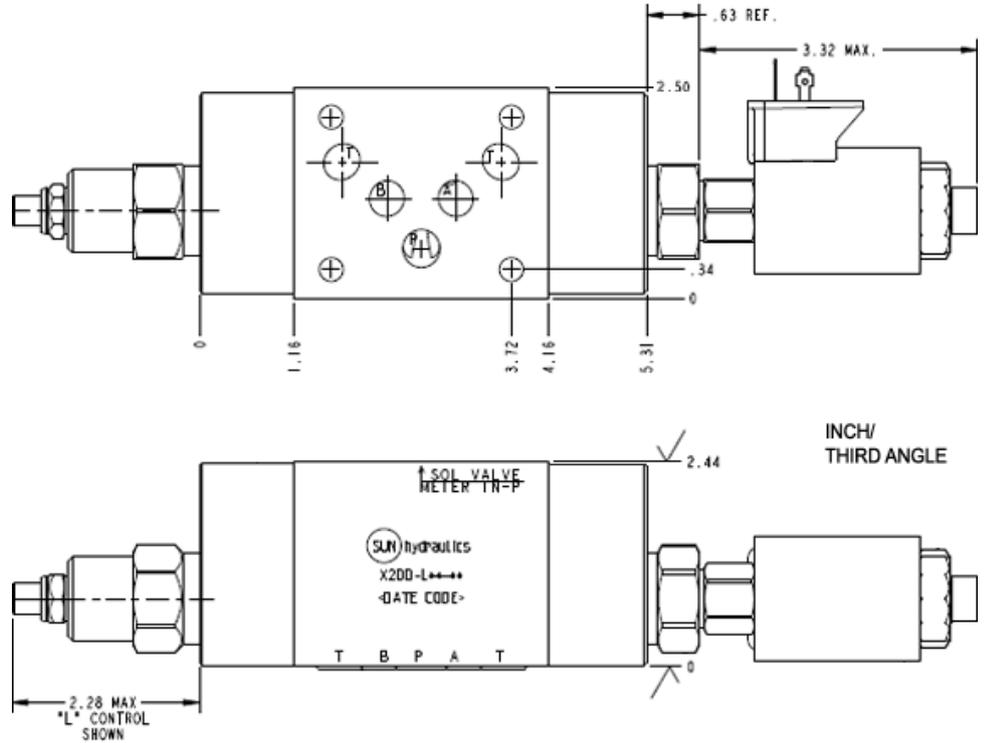
Diese Baugruppe enthält einen einstellbaren Stromregler mit Umgehungs-rückschlagventil, der eine genaue Zulauf- oder Ablaufregelung bei hohen Druckschwankungen erlaubt. Der Stromregler ist voll verstellbar von nahezu geschlossen bis zum maximalen Durchfluss. Ein integriertes, leistungsfähiges Rückschlagventil ermöglicht eine ungehinderte Durchströmung in der Gegenrichtung. Die Vorschubrate wird mit einem stromlos offenen oder geschlossenem 2/2-Wegeventil ausgewählt.
