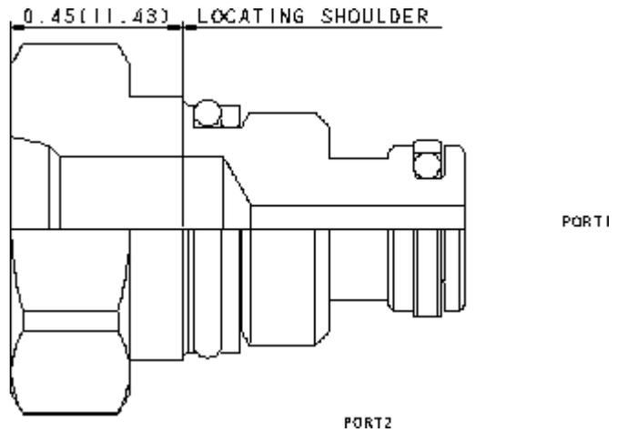
Dieser Verschlussstopfen hat einen mit Anschluss 1 verbundenen externen Anschluss. Anschluss 2 ist gesperrt.
