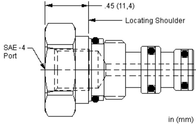
Dieser Verschlussstopfen hat einen mit Anschluss 1 verbundenen externen Anschluss. Die Anschlüsse 2 und 3 sind gesperrt.
