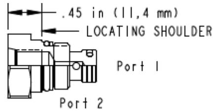
Dieser Verschlussstopfen hat einen mit Anschluss 2 verbundenen externen Anschluss. Anschluss 1 ist gesperrt.
