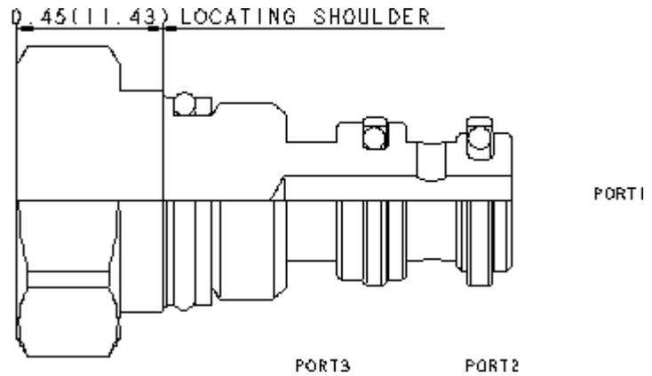
Dieser Verschlussstopfen verbindet die Anschlüsse 1 und 2 und sperrt Anschluss 3.
