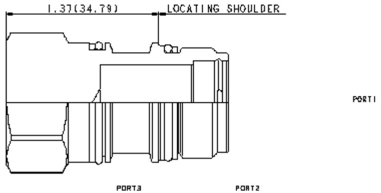
Cet obturateur de cavité met en communication les chambres 1 et 2, et bloque la chambre 3.
