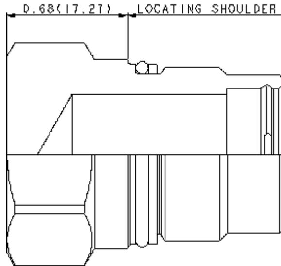
Ces obturbateurs de cavité sont utilisés autant pour les cavités à 2 chambres qu'à 4 chambres et mettent toutes les chambres en communication.
