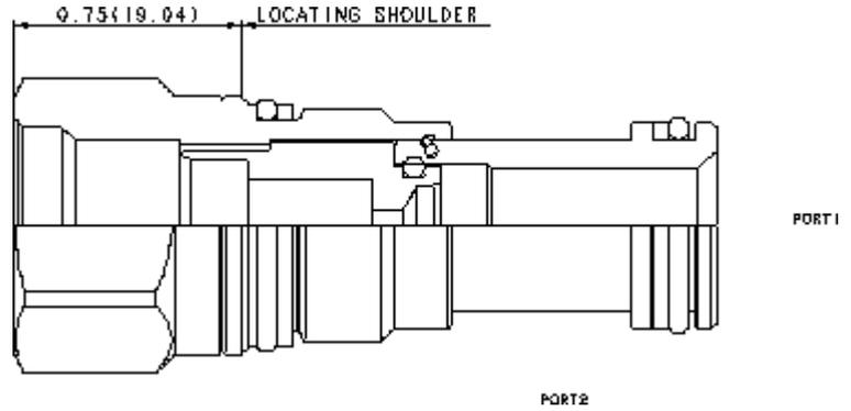
SUN bietet eine Anzahl Einschraubbohrungs-Adapter an, die eine Umstellung von einer Einschraubbohrung auf eine andere ermöglichen. Der XFAA Einschraubbohrungs-Adapter stellt die SUN T-10A Einschraubbohrung auf SUN T-8A um. Dieser Adapter ermöglicht z.B. die Umstellung vor Ort von einem SUN RBAC-\*\*\* Vorsteuer-Druckbegrenzungsventil auf ein SUN RBAP-\*\*\*, proportional Vorsteuer-Druckbegrenzungsventil oder auf jede andere Funktion mit einer T-8A Einschraubbohrung.
