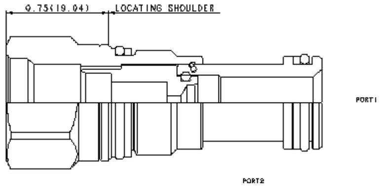
SUN bietet eine Anzahl Einschraubbohrungs-Adapter an, die eine Umstellung von einer Einschraubbohrung auf eine andere ermöglichen. Der XFAA Einschraubbohrungs-Adapter stellt die SUN T-10A Einschraubbohrung auf SUN T-8A um. Dieser Adapter ermöglicht z.B. die Umstellung vor Ort von einem SUN RBAC-\*\*\* Vorsteuer-Druckbegrenzungsventil auf ein SUN RBAP-\*\*\*, proportional Vorsteuer-Druckbegrenzungsventil oder auf jede andere Funktion mit einer T-8A Einschraubbohrung.
