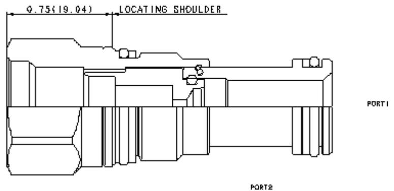
Sun propose une sélection d'adaptateurs de cavités qui servent à convertir une cavité en une autre différente. L'adaptateur XFAA convertit une cavité Sun T-10A en cavité Sun T-8A. Cet adaptateur peut par exemple être utilisé pour remplacer dans une installation existante un étage pilote de limiteur de pression Sun modèle RBAC-\*\*\*, par un limiteur de pression pilote proportionnel Sun modèle RBAP-\*\*\*, ou toute autre fonction T-8A.
