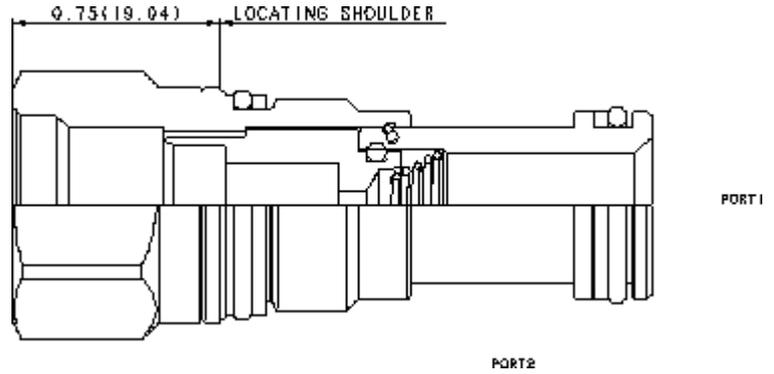
Sun propose une sélection d'adaptateurs de cavité utilisés pour convertir une cavité en une autre. Une fois installé dans une cavité Sun T-10A, cet adaptateur la convertie en cavité Sun T-8A incluant un filtre écran entre les orifices 1 et 2.
