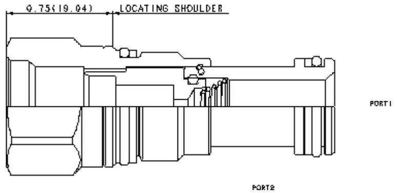
Sun propose une sélection d'adaptateurs de cavité utilisés pour convertir une cavité en une autre. Une fois installé dans une cavité Sun T-10A, cet adaptateur la convertie en cavité Sun T-8A incluant un filtre écran entre les orifices 1 et 2.
