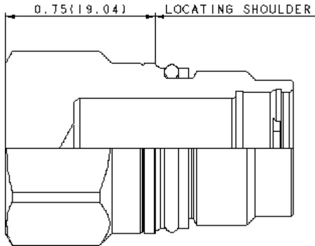
Ces obturateurs de cavité sont utilisés autant pour les cavités à 2 chambres qu'à 4 chambres et mettent toutes les chambres en communication.
