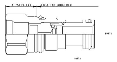
Sun propose une sélection d'adaptateurs de cavité utilisés pour convertir une cavité en une autre. Une fois installée dans une cavité Sun T-13A, cet adaptateur la convertie en cavité Sun T-8A.
