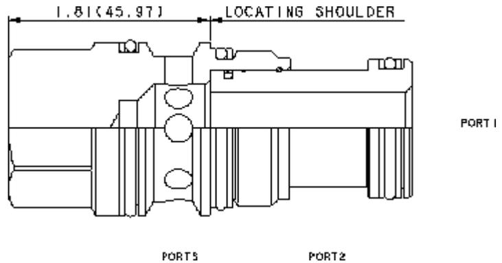
Dieser Verschlussstopfen verbindet die Anschlüsse 1 und 3. Anschluss 2 ist gesperrt.
