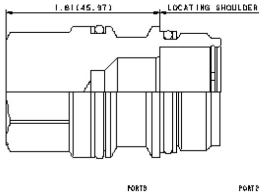
Dieser Verschlussstopfen verbindet die Anschlüsse 1 und 2 und sperrt Anschluss 3.
