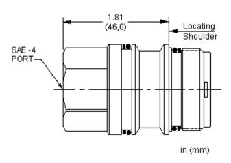
Dieser Verschlussstopfen verbindet Anschlüsse 1 und 2 mit einem externen Anschluss oben auf dem Sechskant und sperrt Anschluss 3.
