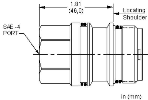
Dieser Verschlussstopfen verbindet Anschlüsse 1 und 2 mit einem externen Anschluss oben auf dem Sechskant und sperrt Anschluss 3.
