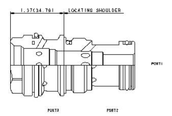
Sun propose une sélection d'adaptateurs de cavité utilisés pour convertir une cavité en une autre. Une fois installée dans une cavité Sun T-17A, cet adaptateur la convertie en cavité Sun T-11A.
