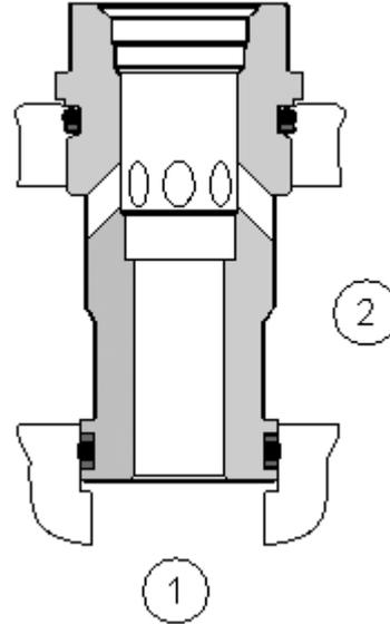
Sun propose une sélection d'adaptateurs de cavité utilisés pour convertir une cavité en une autre. Une fois installé dans une cavité Sun T-16A, cet adaptateur la convertie en cavité Sun T-10A.
