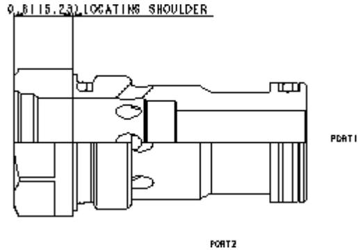
Sun propose une sélection d'adaptateurs de cavité utilisés pour convertir une cavité en une autre. Une fois installée dans une cavité Sun T-16A, cet adaptateur la convertie en cavité Sun T-5A.
