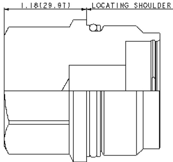
Diese Verschlussstopfen passen in Einschraubbohrungen mit zwei und mit vier Anschlüssen. In beiden Fällen bleiben alle Anschlüsse miteinander verbunden.
