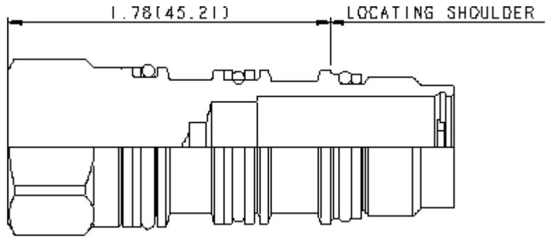
Diese Verschlussstopfen passen in Einschraubbohrungen mit vier und mit sechs Anschlüssen. Beim Einsatz in Einschraubbohrungen mit vier Anschlüssen (T-21A, T-22A, T-23A und T-24A) sind die Anschlüsse 1 und 2 miteinander verbunden und die Anschlüsse 3 und 4 gesperrt. Beim Einsatz in Einschraubbohrungen mit sechs Anschlüssen (T-61A, T-62A, T-63A und T-64A) sind die Anschlüsse 1, 2, 3 und 4 miteinander verbunden und die Anschlüsse 5 und 6 gesperrt.
