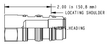
Ces obturateurs de cavité sont utilisés autant pour les cavités à 4 chambres qu'à 6 chambres. Quand ils sont utilisés dans les cavités à 4 chambres (T-21A, T-22A, T-23A et T-24A) les chambres 1 et 2 sont connectées et les chambres 3 et 4 sont bloquées. Quand ils sont utilisés dans les cavités à 6 chambres (T-61A, T-62A, T-63A et T-64A) les chambres 1, 2, 3 et 4 sont connectées et les chambres 5 et 6 sont bloquées.
