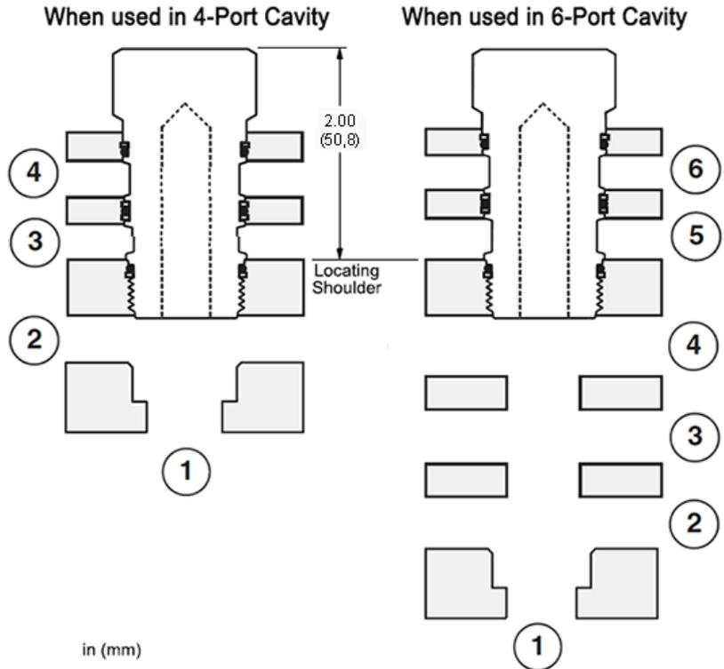
Diese Verschlussstopfen passen in Einschraubbohrungen mit vier und mit sechs Anschlüssen. Beim Einsatz in Einschraubbohrungen mit vier Anschlüssen (T-21A, T-22A, T-23A und T-24A) sind die Anschlüsse 1 und 2 miteinander verbunden und die Anschlüsse 3 und 4 gesperrt. Beim Einsatz in Einschraubbohrungen mit sechs Anschlüssen (T-61A, T-62A, T-63A und T-64A) sind die Anschlüsse 1, 2, 3 und 4 miteinander verbunden und die Anschlüsse 5 und 6 gesperrt.
