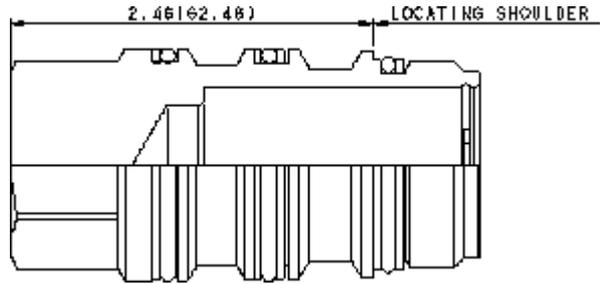
Diese Verschlussstopfen passen in Einschraubbohrungen mit vier und mit sechs Anschlüssen. Beim Einsatz in Einschraubbohrungen mit vier Anschlüssen (T-21A, T-22A, T-23A und T-24A) sind die Anschlüsse 1 und 2 miteinander verbunden und die Anschlüsse 3 und 4 gesperrt. Beim Einsatz in Einschraubbohrungen mit sechs Anschlüssen (T-61A, T-62A, T-63A und T-64A) sind die Anschlüsse 1, 2, 3 und 4 miteinander verbunden und die Anschlüsse 5 und 6 gesperrt.
