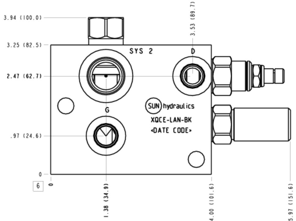
Ce bloc assure la charge d'un accumulateur à partir d'une pompe à débit fixe. Quand la pression atteint le tarage de la valve, la pompe est mise en décharge. Quand la pression diminue jusqu'à la valeur déterminée par le pourcentage fixe de la pilote, la pompe alimente à nouveau le circuit pour recharger l'accumulateur. Le limiteur de pression avec pilotage à distance a une double fonction, comme étage principal pour décharger la pompe et comme limiteur général.
