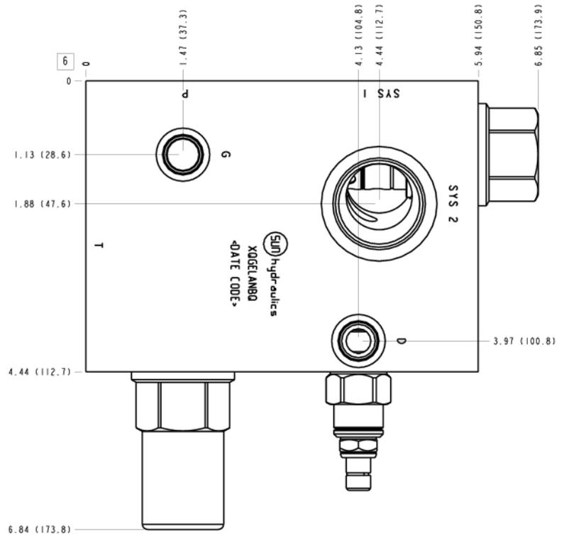
Ce bloc assure la charge d'un accumulateur à partir d'une pompe à débit fixe. Quand la pression atteint le tarage de la valve, la pompe est mise en décharge. Quand la pression diminue jusqu'à la valeur déterminée par le pourcentage fixe de la pilote, la pompe alimente à nouveau le circuit pour recharger l'accumulateur. Le limiteur de pression avec pilotage à distance a une double fonction, comme étage principal pour décharger la pompe et comme limiteur général.
