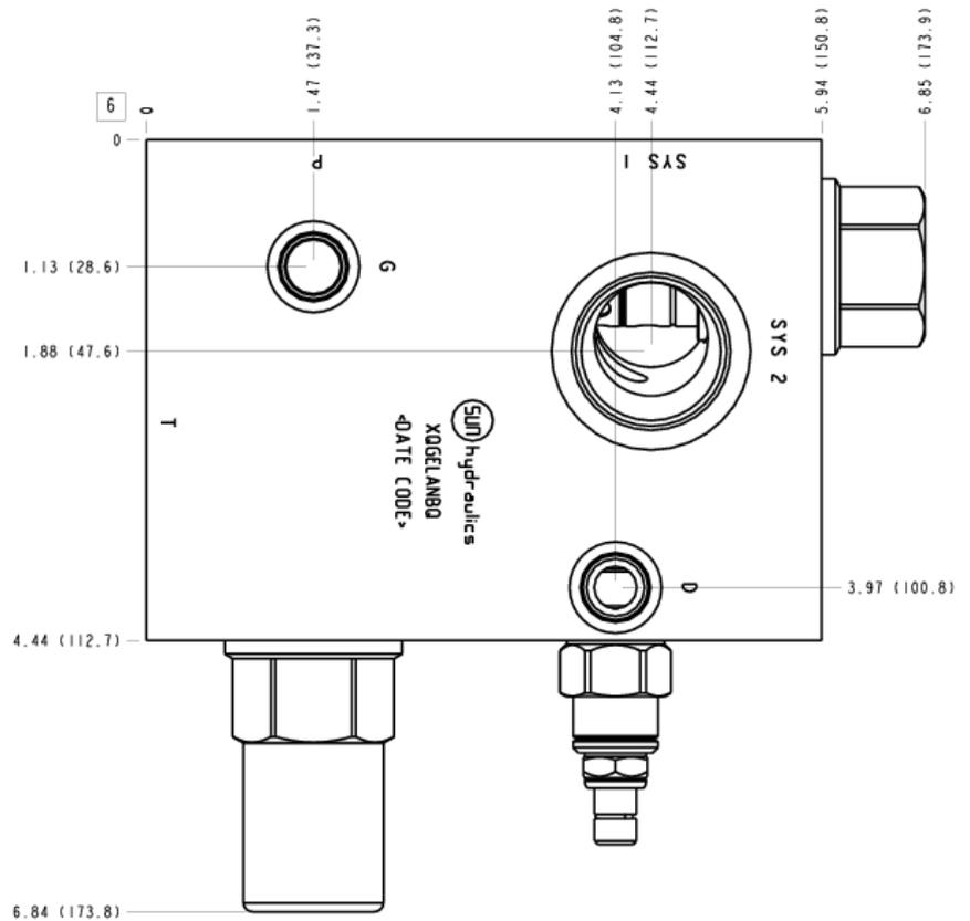
Diese Ventilkombination erlaubt das Aufladen eines Speichers mittels einer Konstantpumpe. Wenn der Druck den Einstellwert des Ventils erreicht, wird die Pumpe entlastet. Wenn der Druck auf den Wert abfällt, der durch die vorgegebene Hysterese des Vorsteuerventils bestimmt ist, wird die Pumpe zugeschaltet, um den Speicher aufzuladen. Das fernsteuerbare Druckbegrenzungsventil erfüllt zwei Funktionen: als Entlastung der Pumpe über den Hauptkolben und als Systemdruckbegrenzung.
