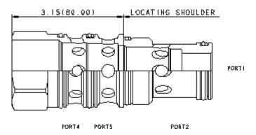
Einschraubbohrungs-Adapter von SUN T-24A auf SUN T-23A.
