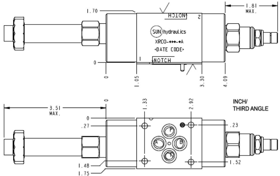
Diese Baugruppe bietet zwei Funktionen. Zum einen Druckbegrenzung von Anschluss 1 zum Tank (Anschluss 2), wenn die Einstellung überschritten wird. Zu anderen ermöglicht ein Magnetventil, das Druckbegrenzungsventil zu entlasten, wodurch der Druck einen minimalen Wert annimmt. Die Baugruppe ist entweder stromlos offen und erzeugt einen niedrigen Druck, bis die Spule bestromt wird oder stromlos geschlossen bei hohem Druck, bis die Spule bestromt wird.
