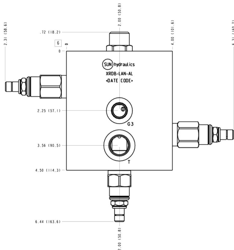
Ce bloc protège les lignes haute pression des transmissions hydrostatiques avec des limiteurs à décharge croisée, et fournit un débit de rinçage. Le débit de rinçage permet d'évacuer de l'huile chaude depuis la ligne basse pression du circuit fermé. La pompe de gavage remplace l'huile chaude et polluée par de l'huile froide et filtrée. L'huile évacuée est également souvent utilisée pour traverser les carters de pompe et de moteur, les rinçant aussi de leur huile chaude et polluée.
