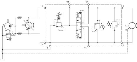
Ce bloc protège les lignes haute pression des transmissions hydrostatiques avec des limiteurs à décharge croisée, et fournit un débit de rinçage. Le débit de rinçage permet d'évacuer de l'huile chaude depuis la ligne basse pression du circuit fermé. La pompe de gavage remplace l'huile chaude et polluée par de l'huile froide et filtrée. L'huile évacuée est également souvent utilisée pour traverser les carters de pompe et de moteur, les rinçant aussi de leur huile chaude et polluée.
