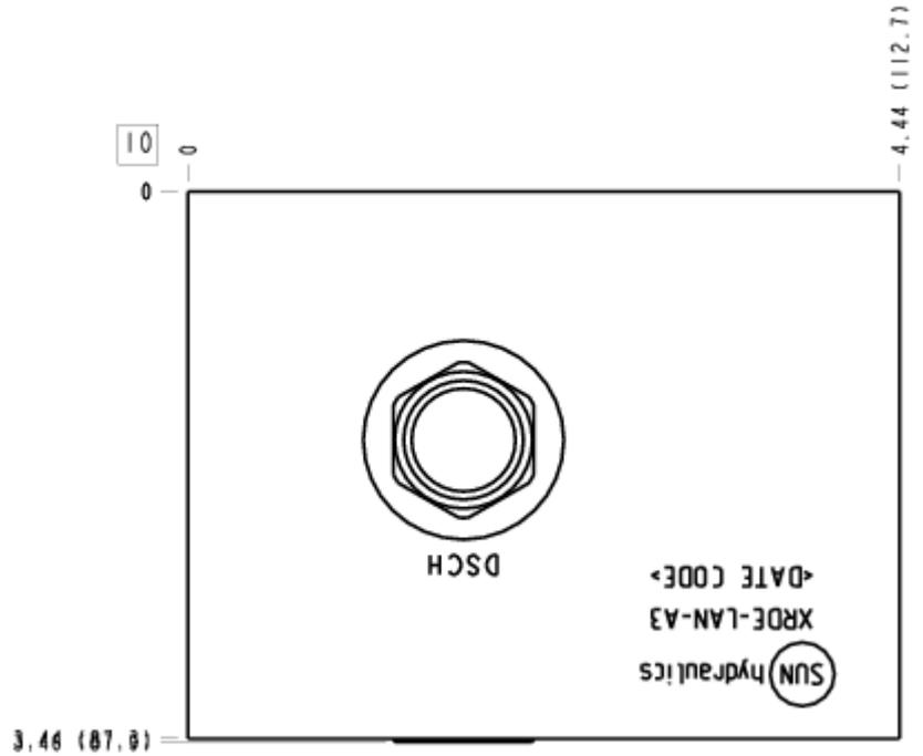
Ce bloc fournit un débit de rinçage pour les transmissions hydrostatiques. Le débit de rinçage permet d'évacuer de l'huile chaude depuis la ligne basse pression du circuit fermé. La pompe de gavage remplace l'huile chaude et polluée par de l'huile froide et filtrée. L'huile évacuée est également souvent utilisée pour traverser les carters de pompe et de moteur, les rinçant aussi de leur huile chaude et polluée.
