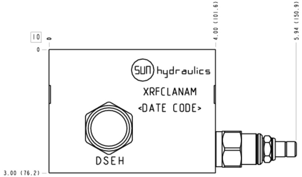
Ce bloc fournit un débit de rinçage pour les transmissions hydrostatiques. Le débit de rinçage permet d'évacuer de l'huile chaude depuis la ligne basse pression du circuit fermé. La pompe de gavage remplace l'huile chaude et polluée par de l'huile froide et filtrée. L'huile évacuée est également souvent utilisée pour traverser les carters de pompe et de moteur, les rinçant aussi de leur huile chaude et polluée.
