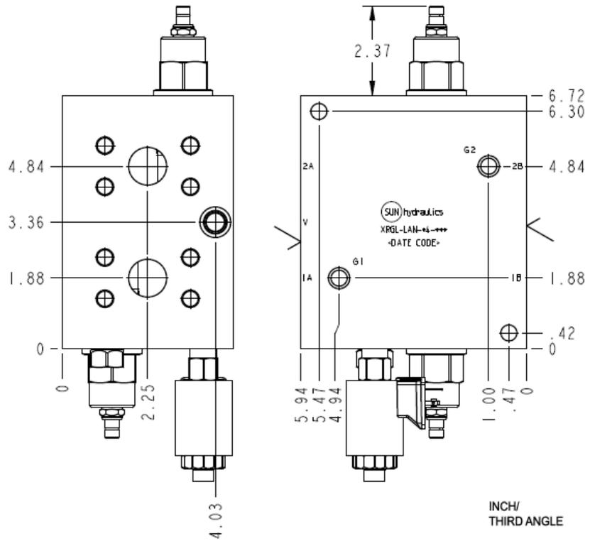
Cette valve assure 2 fonctions. Elle comporte 2 limiteurs de pression à décharge croisés entre les orifices 1 et 2. L'électrovalve permet la mise à vide des 2 limiteurs de pression. La valve est disponible avec une électrovalve normalement ouverte ou normalement fermée. L'option H (normalement ouverte) signifie que la pression est basse tant que l'électrovalve n'est pas excitée. L'option C (normalement fermée) signifie que la pression est haute tant que l'électrovalve n'est pas excitée.
