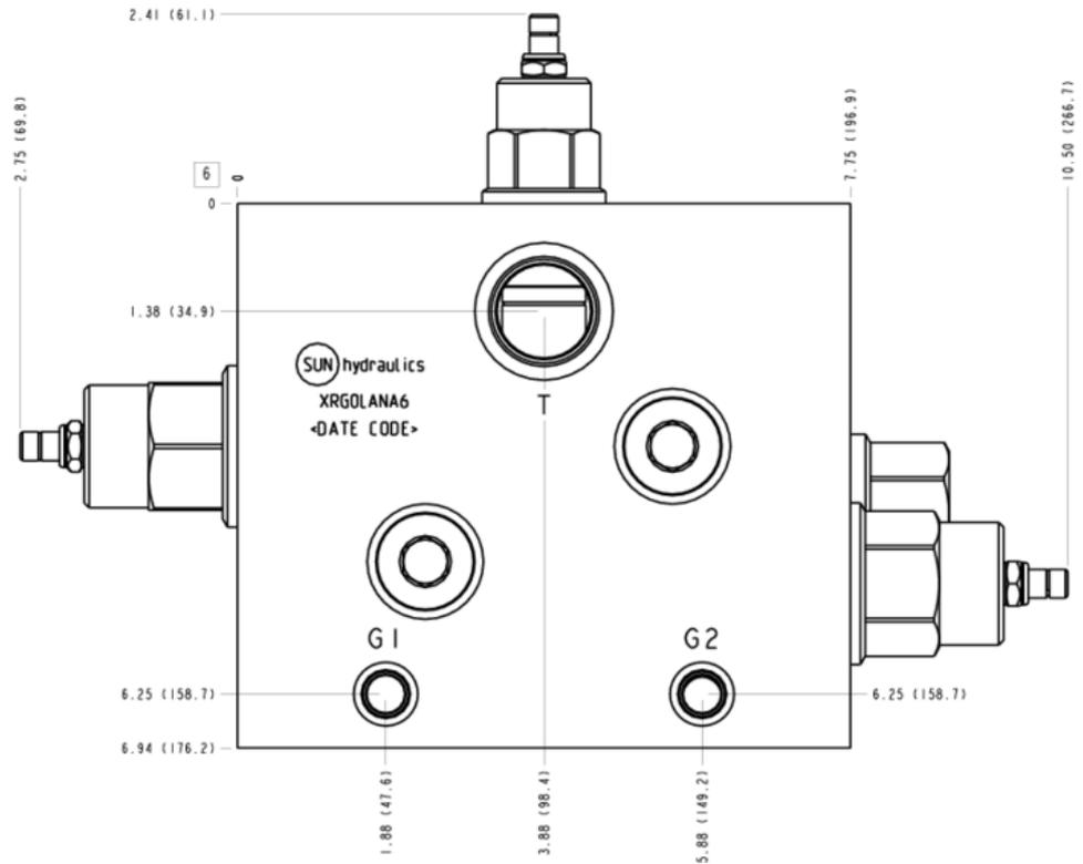
Ce bloc protège les lignes haute pression des transmissions hydrostatiques avec des limiteurs à décharge croisée, et fournit un débit de rinçage. Le débit de rinçage permet d'évacuer de l'huile chaude depuis la ligne basse pression du circuit fermé. La pompe de gavage remplace l'huile chaude et polluée par de l'huile froide et filtrée. L'huile évacuée est également souvent utilisée pour traverser les carters de pompe et de moteur, les rinçant aussi de leur huile chaude et polluée.
