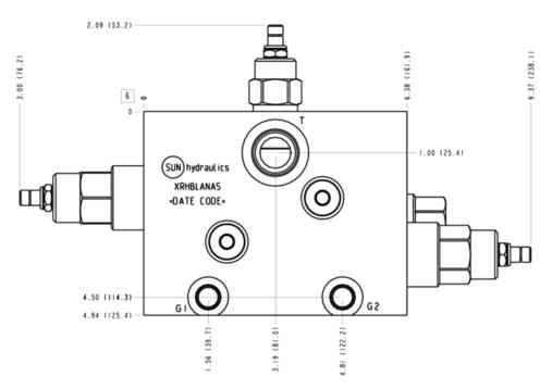
Ce bloc protège les lignes haute pression des transmissions hydrostatiques avec des limiteurs à décharge croisée, et fournit un débit de rinçage. Le débit de rinçage permet d'évacuer de l'huile chaude depuis la ligne basse pression du circuit fermé. La pompe de gavage remplace l'huile chaude et polluée par de l'huile froide et filtrée. L'huile évacuée est également souvent utilisée pour traverser les carters de pompe et de moteur, les rinçant aussi de leur huile chaude et polluée.
