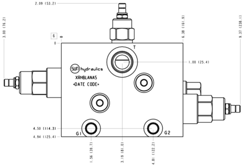
In dieser Ventilkombination sind Doppelschockabsicherung und Spülkreisbeschaltung für geschlossene, hydrostatische Antriebe integriert. Der Spülkreis lässt heißes und ggf. verschmutztes Öl auf der Niederdruckseite ablaufen, während dieser Verlust über eine separate Spülpumpe wieder ausgeglichen wird.
