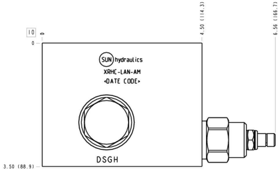
In dieser Ventilkombination ist eine Spülkreisbeschaltung für geschlossene, hydrostatische Antriebe integriert. Der Spülkreis lässt heißes und ggf. verschmutztes Öl auf der Niederdruckseite ablaufen, während dieser Verlust über eine separate Spülpumpe wieder ausgeglichen wird.
