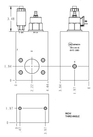
Diese Baugruppe bietet zwei Funktionen. Zum einen Druckbegrenzung von Anschluss 1 zum Tank (Anschluss 2), wenn die Einstellung überschritten wird. Zu anderen ermöglicht ein Magnetventil, das Druckbegrenzungsventil zu entlasten, wodurch der Druck einen minimalen Wert annimmt. Die Baugruppe ist entweder stromlos offen und erzeugt einen niedrigen Druck, bis die Spule bestromt wird oder stromlos geschlossen bei hohem Druck, bis die Spule bestromt wird.
